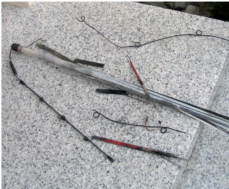
Bild 11: Weggesprengte Teile des UKW-Rundstrahlers (Quelle: DL3YC)
